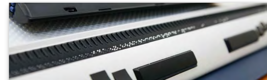
Braillezeile: Der Text wird in Punktschrift angezeigt
